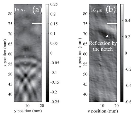
左：1000℃のセラミックス板における超音波の伝播挙動を可視化
